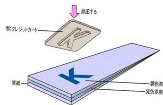
用紙に加圧するだけで、1枚で自己発色します。クレジットカード帳票やキャッシュディスプレイ等のリボンレスの事務機器、計器、またOCR用紙との組み合わせなど、幅広く使用されています。
